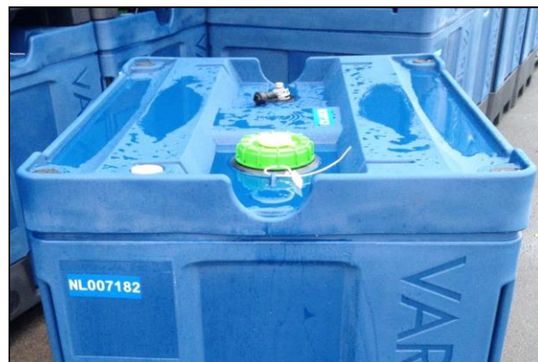
Figura 11: Tanques de ácido com parede dupla
